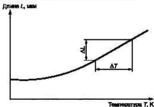
Рисунок 7.2 — Определение среднего коэффициента линейного теплового расширения  $\bar{\alpha}$
