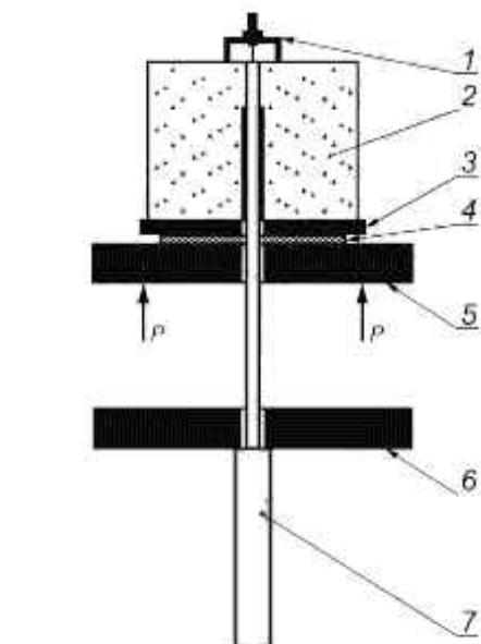
Рисунок 6.2 — Схема испытания образца при осевом выдергивании из куба
