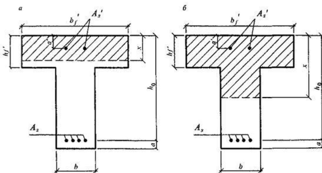
**Рисунок 8.2 - Положение границы сжатой зоны в сечении изгибающего железобетонного элемента**
