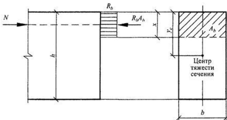
**Рисунок 7.1 - Схема усилий и эпюра напряжений в сечении, нормальном к продольной оси внецентренно сжатого бетонного элемента, рассчитываемого по прочности без учета сопротивления бетона растянутой зоны**
