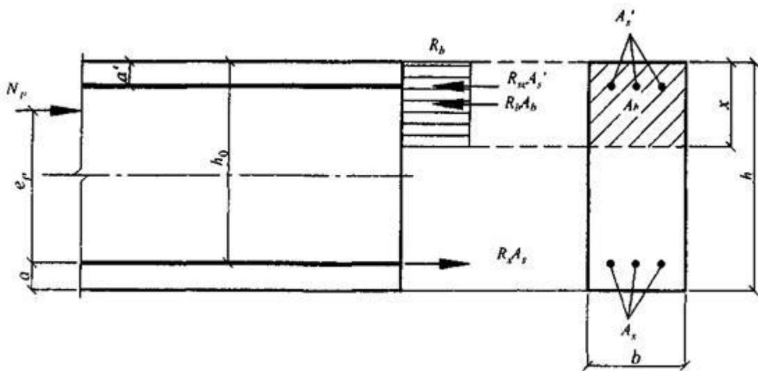
**Рисунок 9.1 - Схема усилий и эпюра напряжений в сечении, нормальному к продольной оси изгибающего предварительно напряженного элемента при его расчете по прочности в стадии обжатия**
