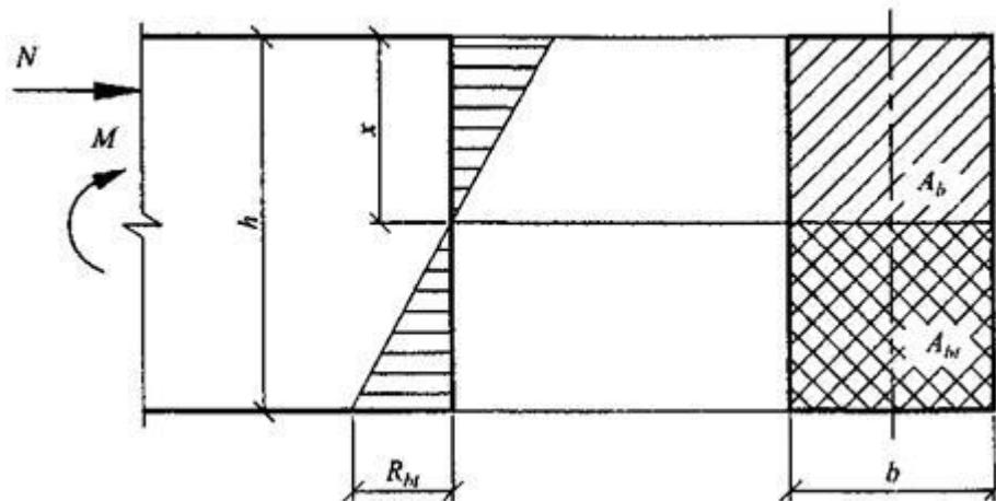
**Рисунок 7.2 - Схема усилий и эпюра напряжений в сечении, нормальном к продольной оси изгибаемого (внеклентренно сжатого) бетонного элемента, рассчитываемого по прочности с учетом сопротивления бетона растянутой зоны**
