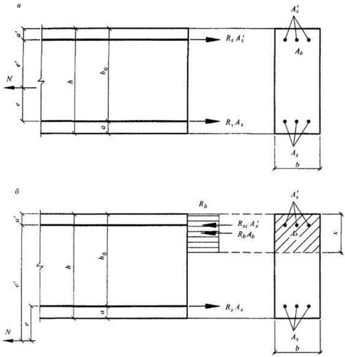
*a* - между равнодействующими усилий в арматуре  $S$  и  $S'$ ; *б* - за пределами расстояний между равнодействующими усилий в арматуре  $S$  и  $S'$
