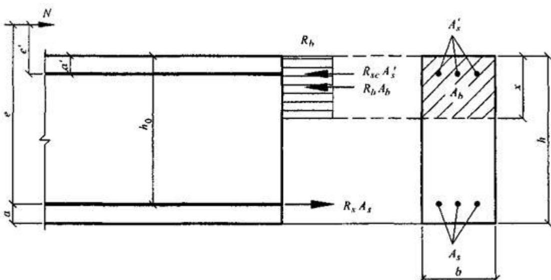
**Рисунок 8.3 - Схема усилий и эпюра напряжений в сечении, нормальному к продольной оси внецентренно сжатого железобетонного элемента, при расчете его по прочности**
